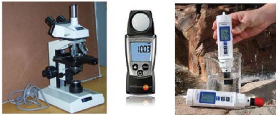
รูปที่ 1.9 กล้องจุลทรรศน์ เครื่องวัดความเข้มแสงและเครื่องมือวัดออกซิเจน ในน้ำ
