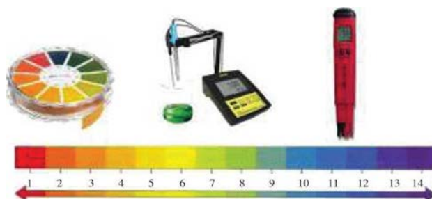
รูปที่ 1.10 pH meter เป็นเครื่องมือวัดความเป็นกรด-ด่าง (pH) ของสารละลาย
